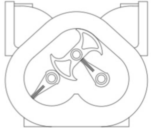
Rotores metros são projetados para trabalhar em conjunto com tolerâncias apertadas e a parede da câmara de fluido. São observados espaços ligeiras entre os rotores e a parede da câmara. Devido a isto, é importante que o medidor está corretamente aplicada ao fluxo e pressão de operação do sistema.
