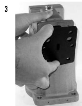
1. Para quitar el conjunto eliminador de aire, retire los cuatro tornillos y arandelas que lo sujetan al conjunto del filtro.
