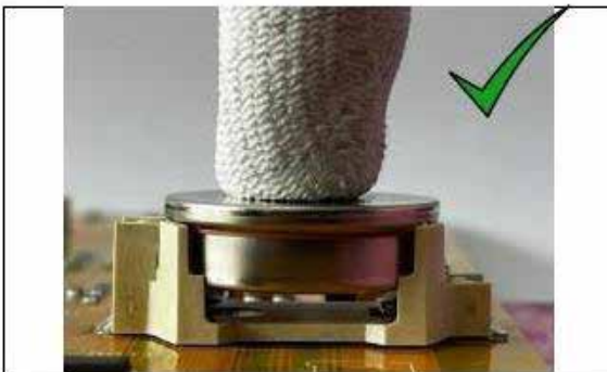
Figura 1. Instalación correcta de la batería CR2477N
