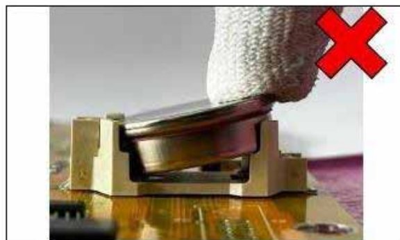
Figura 4. Instalación incorrecta de la batería CR2477N
