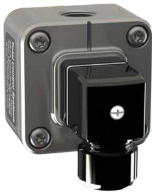
INSTALADO CORRETAMENTE: Direcione a entrada do conduíte para baixo para evitar a migração de umidade para o interior do conduíte.
